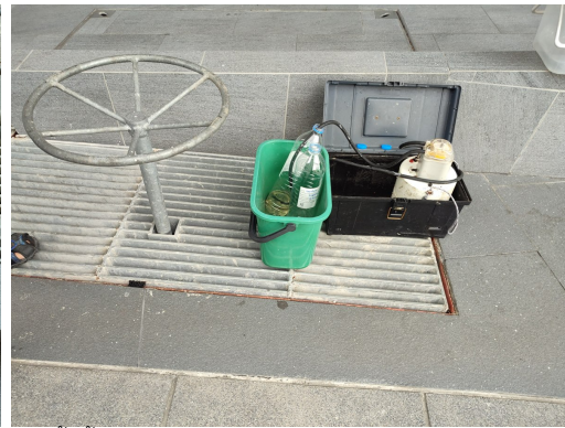
การเก็บตัวอย่างน้ำทิ้งที่บ่อตรวจคุณภาพน้ำทิ้ง ด้วยวิธี Sampling Pump
