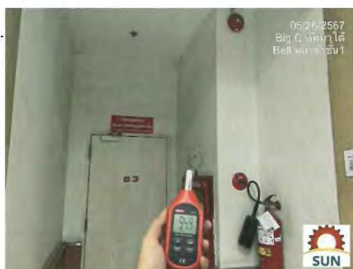
รูปที่ 2.77 ทดสอบ Alarm Bell พื้นที่บริเวณประตูหนีไฟ G3 และ วัดค่าเสียงได้ที่ 95.4
