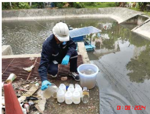
จุดเก็บบ่อบำบัดสุดท้ายก่อนระบายออกสู่แหล่งน้ำสาธารณะ
