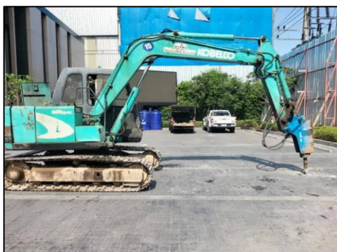
รูปที่ 127 รถขุดติดตั้งหัวสกัดคอนกรีต
