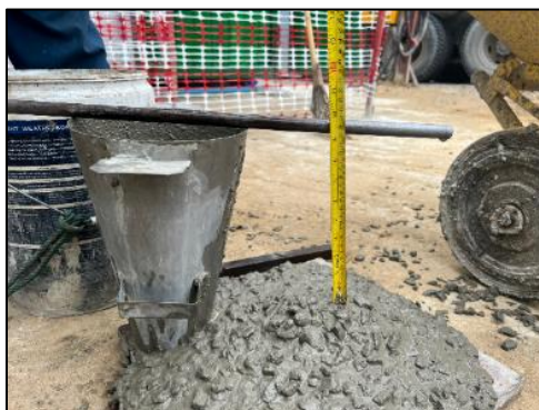
รูปที่ 78 ตรวจวัดค่าการยุบตัว และอุณหภูมิของคอนกรีต
