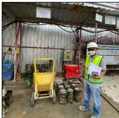
รูปที่ 79 เจ้าหน้าที่เก็บตัวอย่างคอนกรีต (ลูกปูน)
