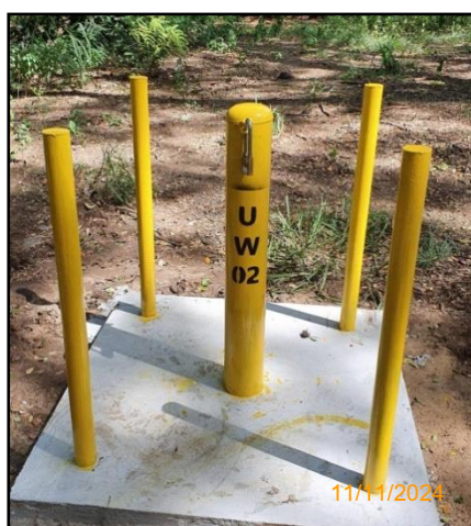
รูปที่ 2-27 ป่อสังเกตการณ์ (Monitoring Well) บริเวณพื้นที่โครงการ
