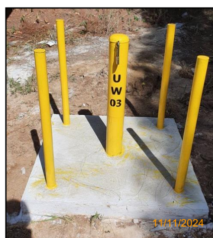
รูปที่ 2-27 ป่อสังเกตการณ์ (Monitoring Well) บริเวณพื้นที่โครงการ
