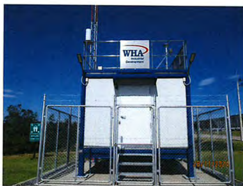
ภาพที่ 3.3.2-2 สถานีตรวจวัดคุณภาพอากาศแบบอัตโนมัติ บริเวณสำนักงานนิคมฯ
