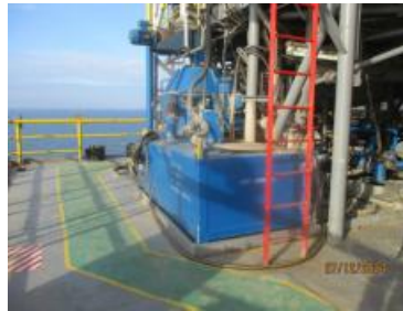
ภาพถ่ายที่ 2.2-12 ระบบ Solid Control System บนแท่นเจาะ
