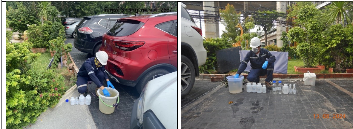
การเก็บตัวอย่างที่บ่อดักขยะและตรวจคุณภาพน้ำ ก่อนระบายสู่ภายนอกโครงการ
