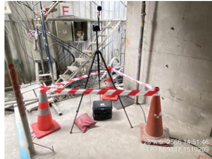
รูปที่ 19 เครื่องตรวจวัดระดับแรงสั่นสะเทือน
