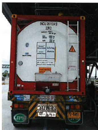
ภาพที่ 2-11 (ต่อ) รถขนส่งกากของเสียที่ติดตั้งระบบ GPS และติดเบอร์โทรศัพท์ และการติดป้ายความเป็นอันตราย พร้อมอุปกรณ์ระงับเหตุ
