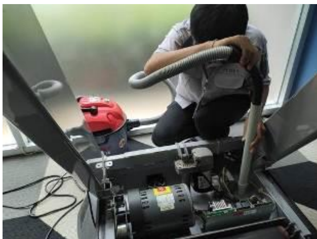
ช่างอาคารฯ ดำเนินการตรวจเช็คและทำความสะอาดเครื่องสูวี่ง ห้องออกกำลังกาย
