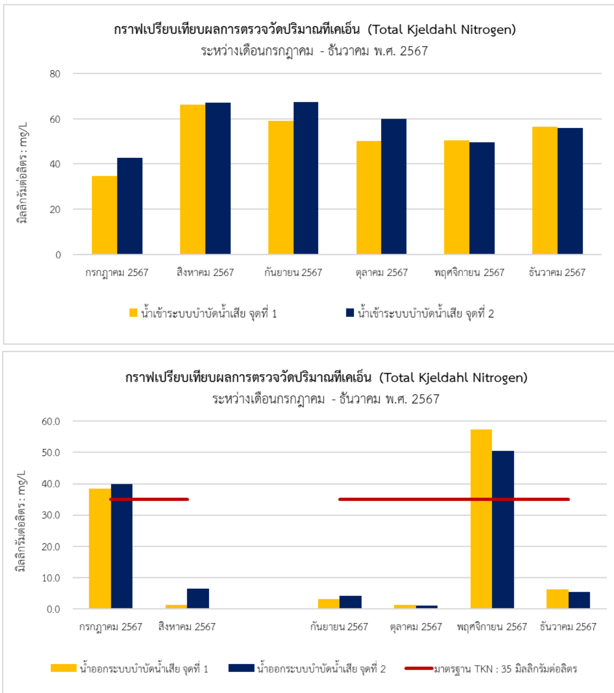
รูปที่ 4.1-9 กราฟผลการตรวจวิเคราะห์ปริมาณไนโตรเจนทั้งหมด (TKN) เดือนกรกฎาคม ถึงเดือนธันวาคม พ.ศ. 2567
