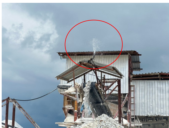
ภาพที่ 2-16 ระบบสเปรย์น้ำตามจุดกำเนิดฝุ่น
