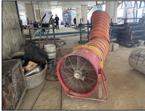
รูปที่ 80 พัดลมระบายอากาศภายในพื้นที่โครงการ
