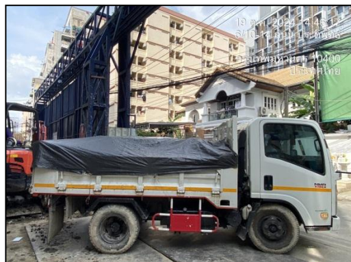
รูปที่ 26 รถบรรทุกขนส่งวัสดุก่อสร้าง ปิดคลุมผ้าใบมิดชิด
