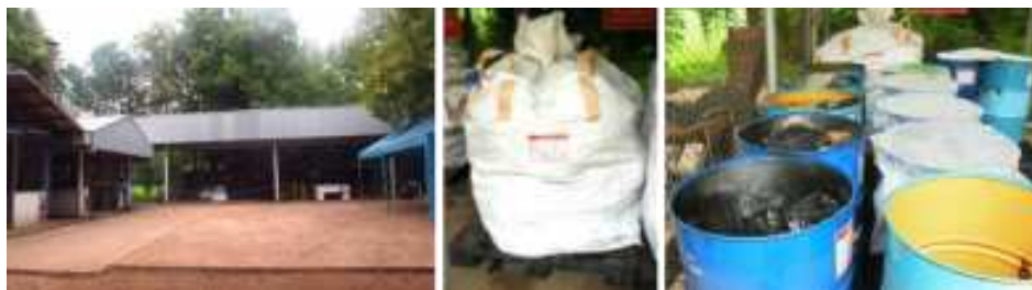
รูปที่ 3-5 ตัวอย่างภาชนะจัดเก็บของเสียอันตรายประเภทต่างๆ
