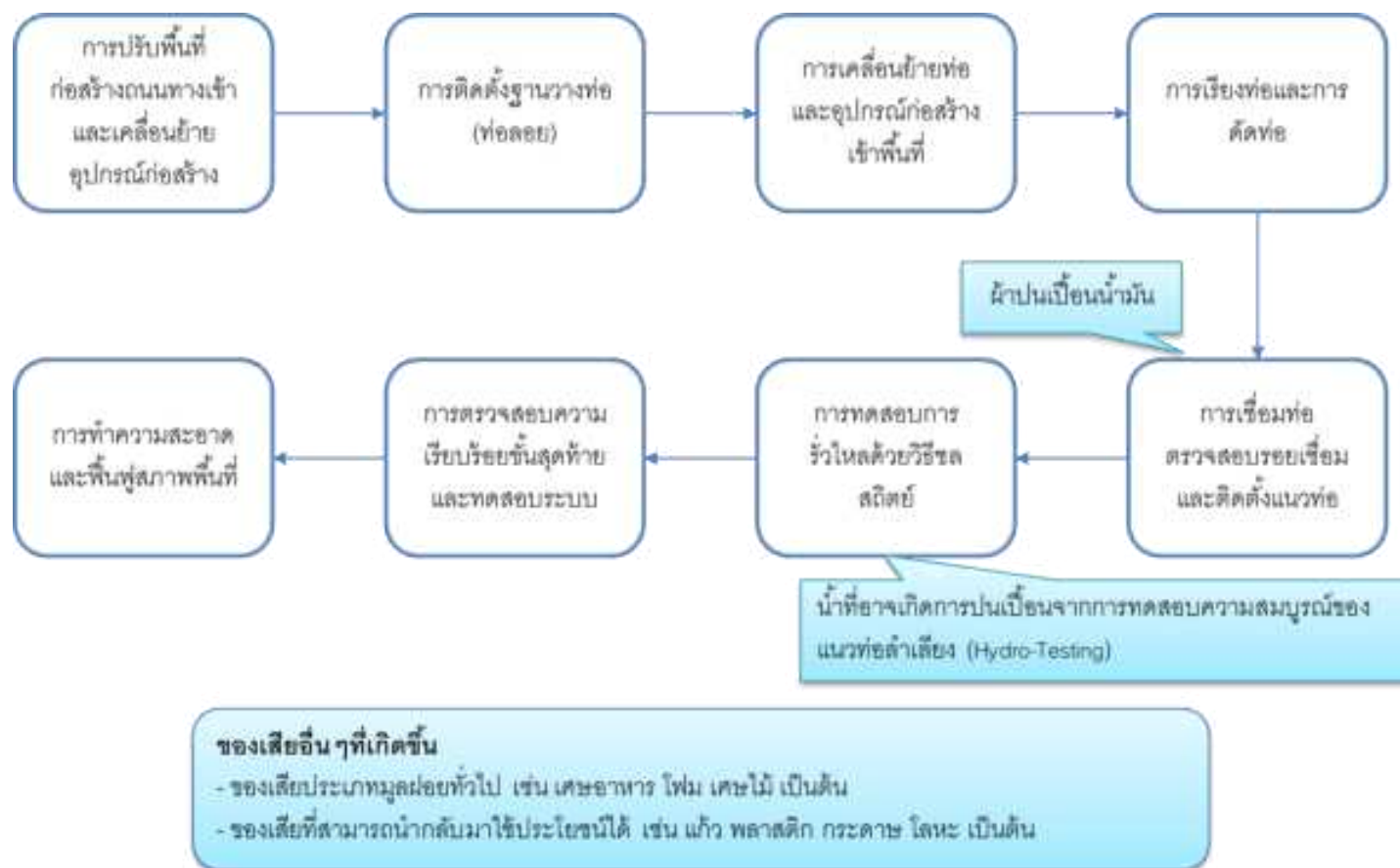
รูปที่ 2-22 แผนผังกระบวนการและแหล่งที่มาของของเสียในระยะก่อสร้างและติดตั้งท่อลำเลียง
