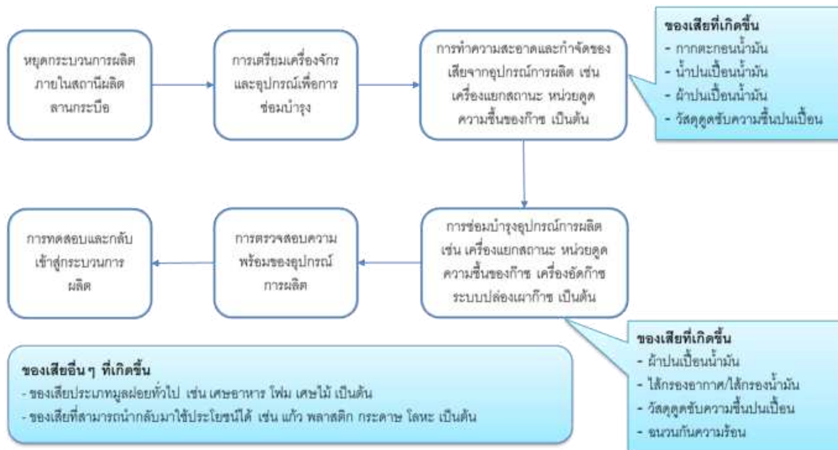
รูปที่ 2-19 แผนผังกระบวนการและแหล่งที่มาของของเสียระยะผลิตปิโตรเลียม (การหยุดผลิตปิโตรเลียมชั่วคราวเพื่อซ่อมบำรุง (Shutdown))
