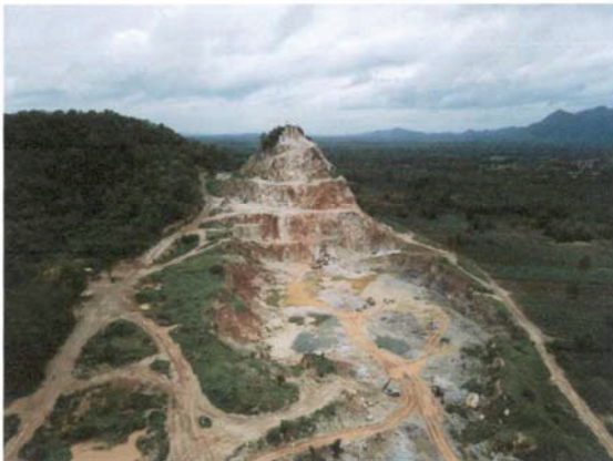
รูปที่ 4 แสดงสภาพพื้นที่หน้าเหมืองบริเวณด้านทิศตะวันออกของประทานบัตร เดินหน้าเหมืองไปทางทิศเหนือ มีการทำเหมืองเป็นแบบชั้นบันได
