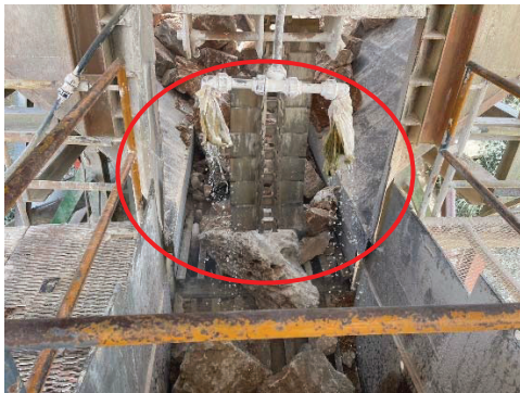
รูปที่ 2-25: ระบบสเปรย์น้ำโรงโม่
