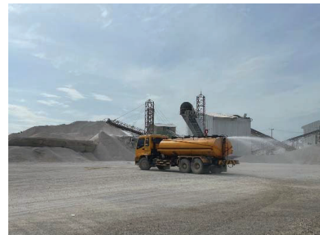
รูปที่ 2-18: การฉีดพรมน้ำบริเวณโรงโม่หิน
