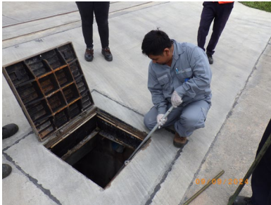
ภาพที่ 2-12 ปอดตรวจวัดคุณภาพน้ำทิ้งสุดท้าย (Inspection manhole) เพื่อตรวจสอบคุณภาพน้ำเสีย
