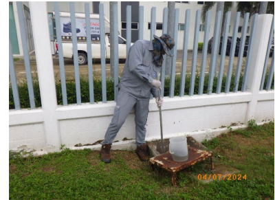
ภาพที่ 2-12 ปอดตรวจวัดคุณภาพน้ำทิ้งสุดท้าย (Inspection manhole) เพื่อตรวจสอบคุณภาพน้ำเสีย
