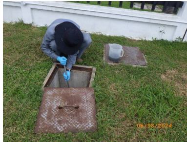
ภาพที่ 2-12 ปอดตรวจวัดคุณภาพน้ำทิ้งสุดท้าย (Inspection manhole) เพื่อตรวจสอบคุณภาพน้ำเสีย
