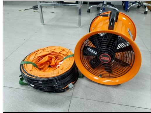
รูปที่ 35 พัฒนาระบายอากาศชนิดเคลื่อนที่ได้
