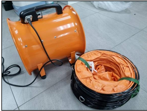
รูปที่ 35 พัฒนาระบายอากาศชนิดเคลื่อนที่ได้
