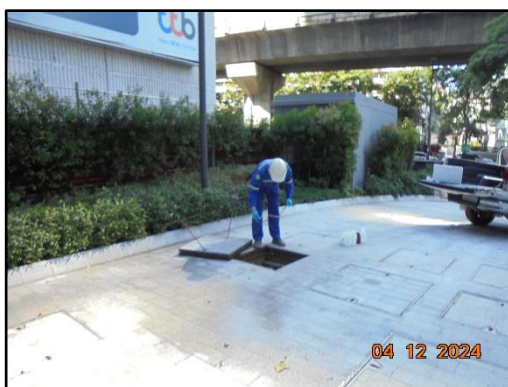
รูปที่ 3.3-1 จุดตรวจวัดคุณภาพน้ำทิ้ง บริเวณถังสูบน้ำทิ้ง ประจำเดือนกรกฎาคม - ธันวาคม พ.ศ. 2567
