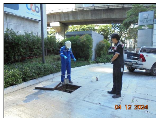
รูปที่ 3.3-1 จุดตรวจวัดคุณภาพน้ำทิ้ง บริเวณถังสูบน้ำทิ้ง ประจำเดือนกรกฎาคม - ธันวาคม พ.ศ. 2567
