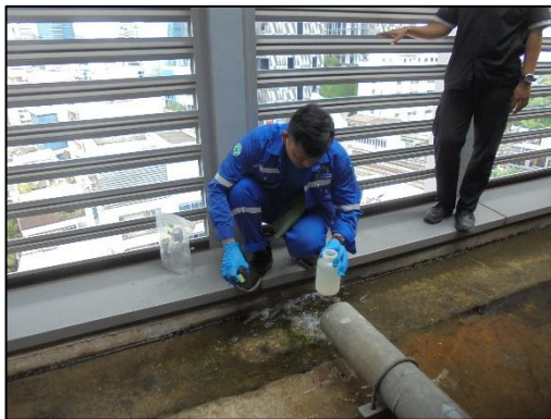
รูปที่ 3.2-3 จุดตรวจวัดคุณภาพน้ำห่อฝึงเย็น บริเวณท่อน้ำทิ้งจากห่อฝึงเย็น ประจำเดือนกรกฎาคม - ธันวาคม พ.ศ. 2567
