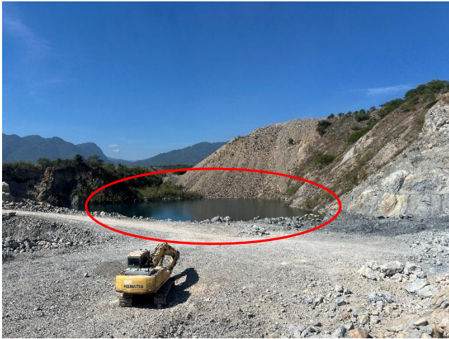
รูปที่ 2-9 จุดที่เป็นพื้นที่ต่ำที่ใช้เป็นพื้นที่รองรับปริมาณน้ำ ไหลบ่าจากพื้นที่หน้าเหมือง
