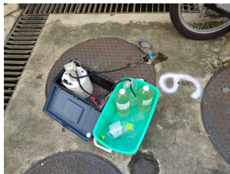
ภาพที่ 5-28 การเก็บตัวอย่างน้ำทิ้งที่บ่อเกรอะและบ่อพักน้ำใส
