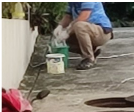
ภาพที่ 5-28 การเก็บตัวอย่างน้ำทิ้งที่บ่อเกรอะและบ่อพักน้ำใส
