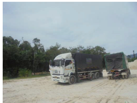
รูปที่ 2-11: การปิดคลุมผ้าใบรถบรรทุกแร่
