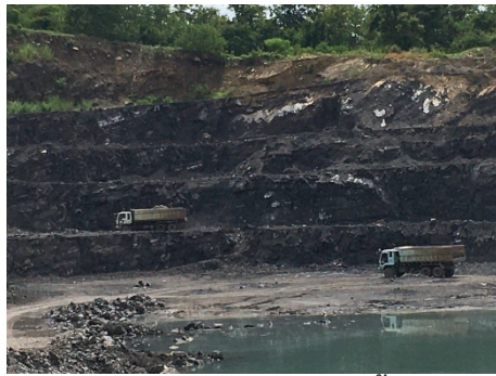
รูปที่ 2-1: การทำเหมืองแบบขั้นบันได
