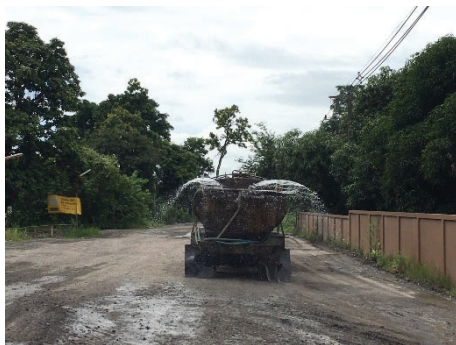
รูปที่ 2-9: การฉีดพรมน้ำเส้นทางขนส่งแร่
