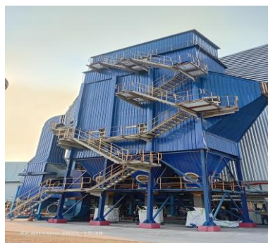
ภาพที่ 2.2-4 ระบบ ESP บริเวณปล่อง Biomass
