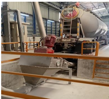
ภาพที่ 2.2-1 ระบบควบคุมฝุ่นระหว่างการขนถ่าย PTA จากรถบรรทุก
