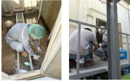
รูปที่ 3-10 การตรวจวิเคราะห์คุณภาพน้ำของระบบ Cooling Tower
