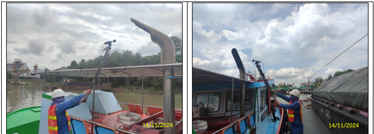
รูปที่ 3-11 การตรวจวัดระดับเสียงของเรือลากจูงที่เข้าเทียบท่า
