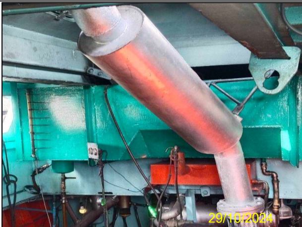
ฉ) การติดตั้งตัวเก็บเสียง (Silencer) เรือยนต์ลากจูง เพื่อลดผลกระทบเรื่องเสียง
