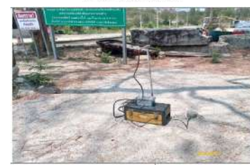
การตรวจวัดความสั่นสะเทือน ขอบแปลงประทานบัตรทางด้านทิศตะวันออก
