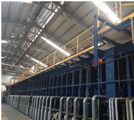
รูปที่ 2-1 การปิดครอบเครื่องจักรของโรงงาน
