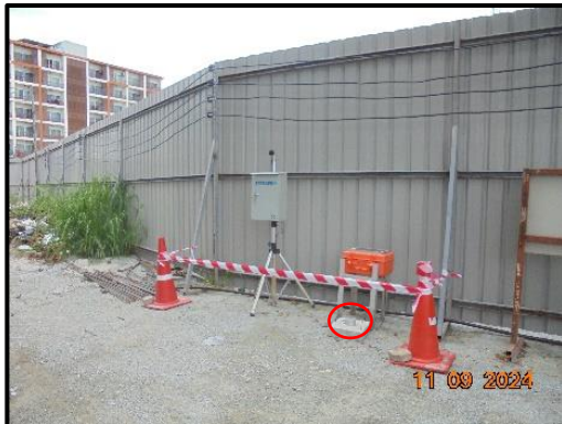
รูปที่ 74 การตรวจวัดความสั่นสะเทือน บริเวณพื้นที่ก่อสร้าง
