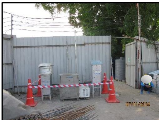
รูปที่ 72 การตรวจวัดปริมาณฝุ่นละออง บริเวณพื้นที่ก่อสร้าง
