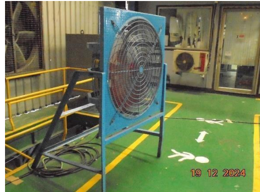
รูปที่ 28 ระบบระบายอากาศและพัดลมระบายอากาศบริเวณพื้นที่ปฏิบัติงานมีสัมผัสความร้อน
