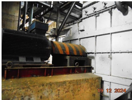
รูปที่ 33 การติดตั้งการ์ดป้องกันอันตรายบริเวณเครื่องจักร
