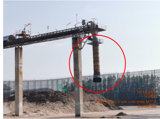
รูปที่ 6 ท่อ Chute/ที่ครอบกันฝุ่นฟุ้งกระจาย
