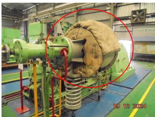
รูปที่ 27 ป้ายเตือนบริเวณที่เป็นแหล่งกำเนิดความร้อนสูงและการติดฉนวนป้องกันความร้อน
