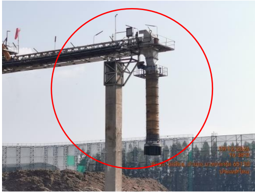
รูปที่ 6 ท่อ Chute/ที่ครอบกันฝุ่นฟุ้งกระจาย
