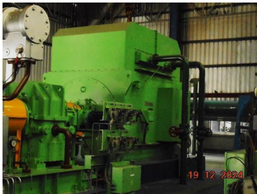
รูปที่ 10 การปิดครอบเครื่องจักรที่มีเสียงดัง
