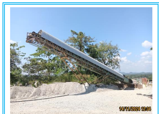
รูปที่ 2.3-3 สายพานสำหรับลำเลียงขนส่งแร่
