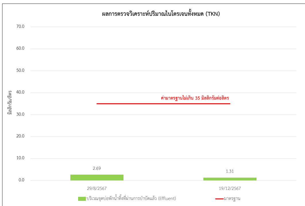
รูปที่ 4.1-6 กราฟเปรียบเทียบผลการตรวจวิเคราะห์ปริมาณไนโตรเจนทั้งหมด (TKN)
