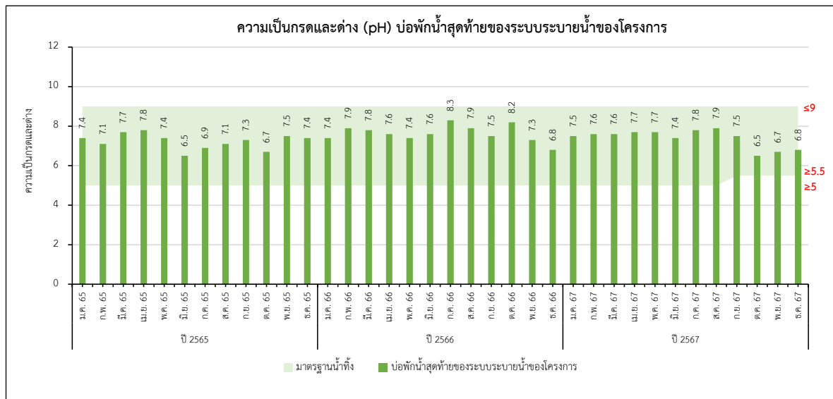
รูปที่ 3-21 เปรียบเทียบค่าความเป็นกรดและด่าง บ่อพักน้ำสุดท้ายของระบบระบายน้ำของโครงการ ก่อนระบายลงสู่ระบบระบายน้ำบริเวณด้านหน้าโครงการ
