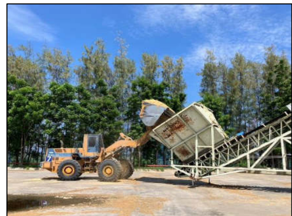
รูปที่ 14 การใช้รถตักล้อยาง (Front Loader) ตักแกลบใส่รถสายพานลำเลียง
