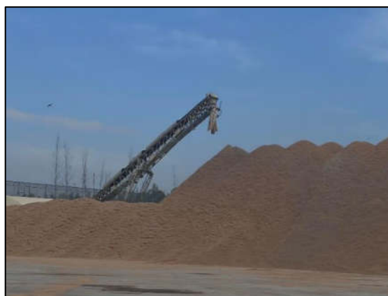
รูปที่ 15 การติดตั้งท่อยืด (Bellow) บริเวณส่วนปลายของสายพานลำเลียง
