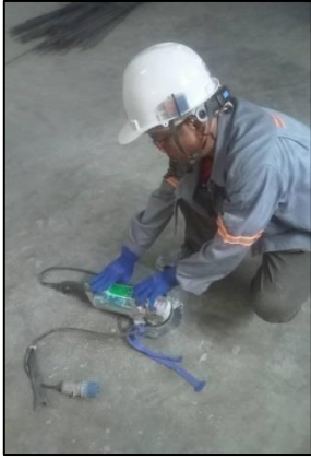
รูปที่ 17 การตรวจสอบเครื่องมือหรืออุปกรณ์ไฟฟ้าของโครงการ
