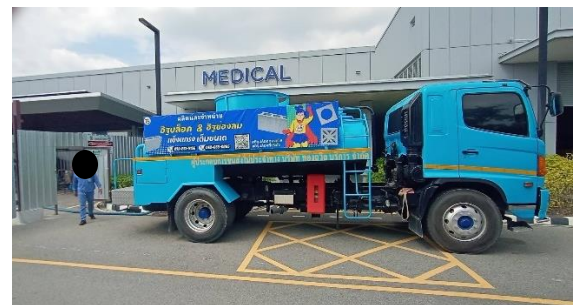
รูปที่ 2-14 การสูบน้ำทิ้งจากระบบบำบัดน้ำเสียไปกำจัด
