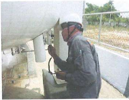
รูปการทดสอบและตรวจสอบค่าสูญญากาศ
