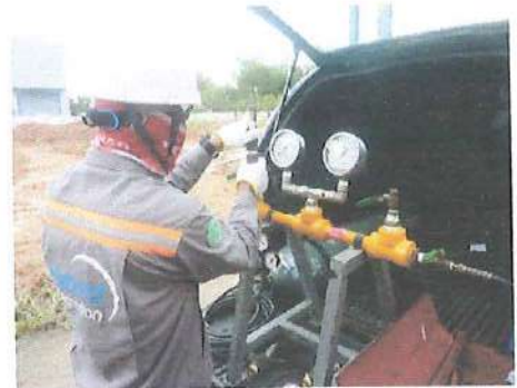
รูปการทดสอบและตรวจสอบอุปกรณ์ควบคุมความดันก๊าซเกินพิกัดแบบระบายสถานที่ใช้ LNG
