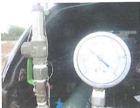
รูปการทดสอบและตรวจสอบอุปกรณ์ควบคุมความดันก๊าซเกินพิกัดแบบระบายสถานที่ใช้ LNG
