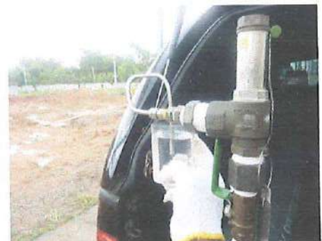
รูปการทดสอบและตรวจสอบอุปกรณ์ควบคุมความดันก๊าซเกินพิกัดแบบระบายสถานที่ใช้ LNG
