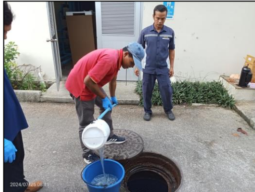
รูปที่ 3.1 แสดงการเก็บตัวอย่างน้ำเสียก่อนเข้าระบบ
