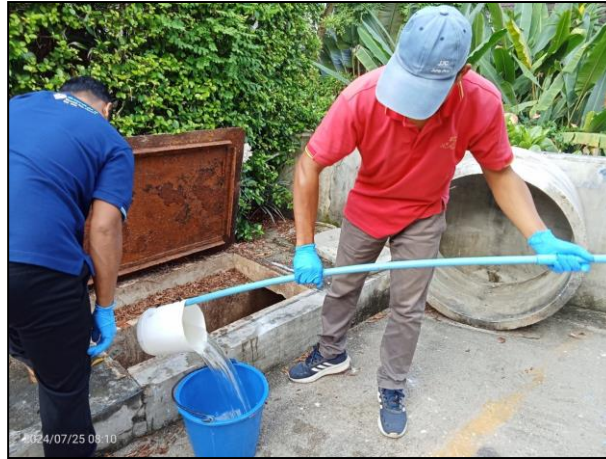
รูปที่ 3.2 แสดงการเก็บตัวอย่างน้ำออกจากระบบบำบัด
