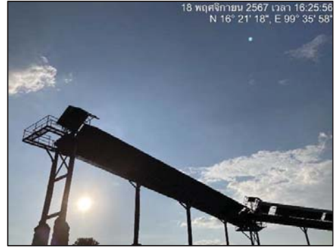
ภาพที่ 11 ระบบสายพานลำเลียงแบบปิดกากอ้อย
