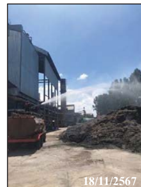
ภาพที่ 18 ฉีดพรมน้ำผิวหน้ากองเถ้าระหว่างรอกขนส่งกรณีหน้ากองเถ้าแห้ง
