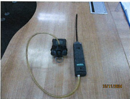
ภาพที่ 2-44 Gas Detector
