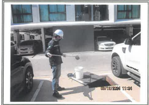
รูปที่ 3-4 การเก็บตัวอย่างคุณภาพน้ำทิ้ง บริเวณบ่อสูบน้ำทิ้งหลังการบำบัด อาคาร C-B
