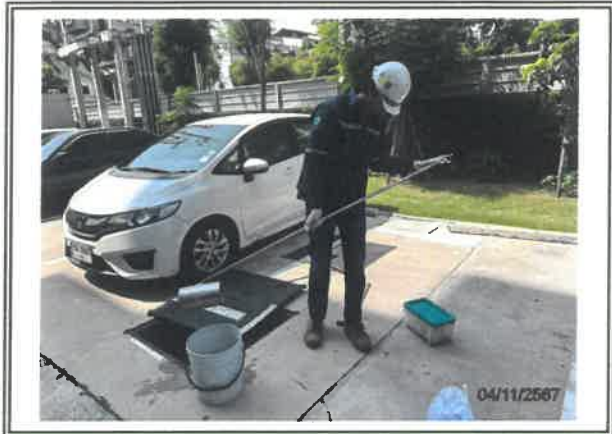
รูปที่ 3-3 การเก็บตัวอย่างคุณภาพน้ำทิ้ง บริเวณบ่อสูบน้ำทิ้งหลังการบำบัด อาคาร A-D
