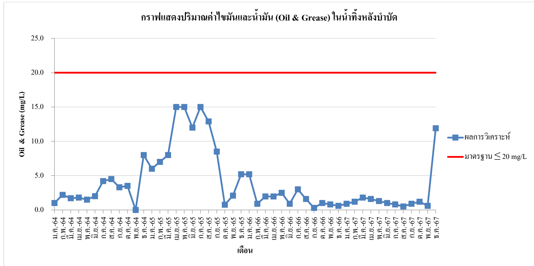
ภาพที่ 4-13 แสดงปริมาณค่าไขมันและน้ำมัน (Oil & Grease) ในน้ำทิ้งหลังบำบัด
