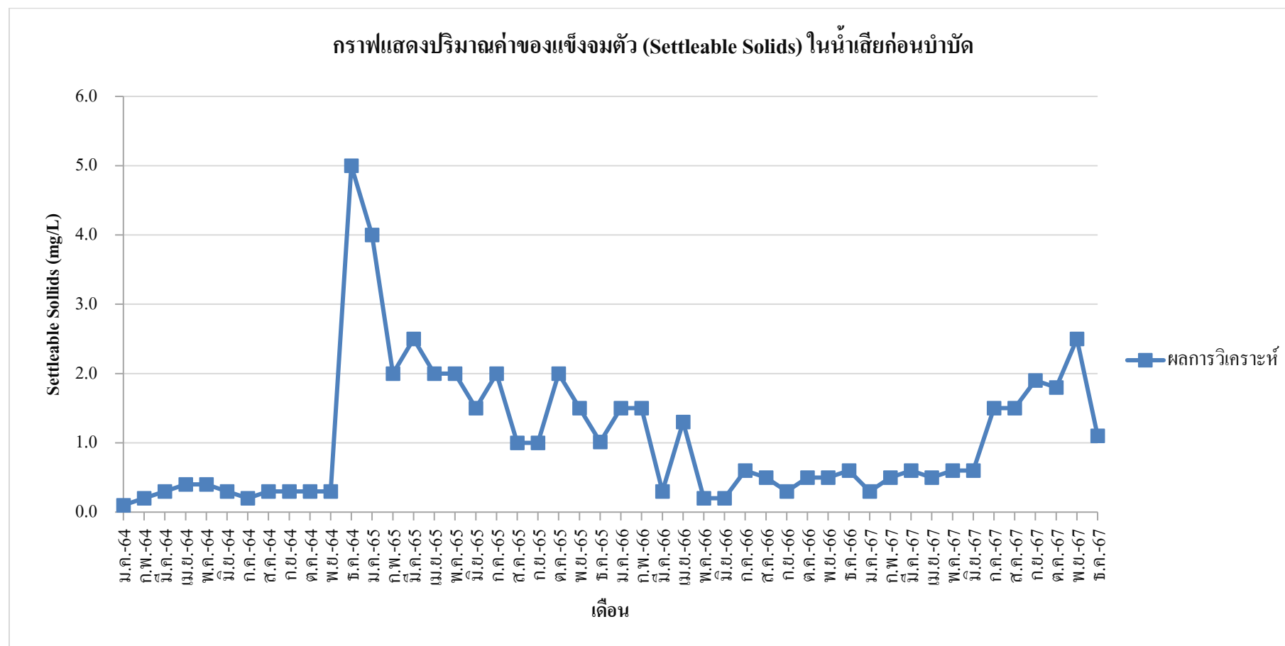
ภาพที่ 4-7 แสดงปริมาณค่าตะกอนหนัก (Settleable Solids) ในน้ำเสียก่อนบำบัด
