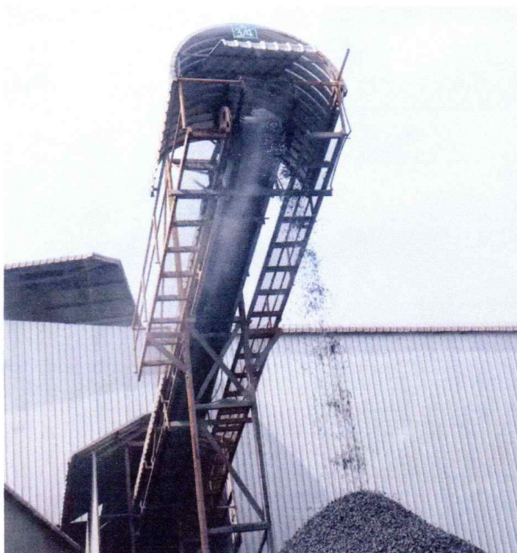
มีการสเปรย์น้ำบริเวณปลายสายพานเพื่อลดฝุ่นละออง
