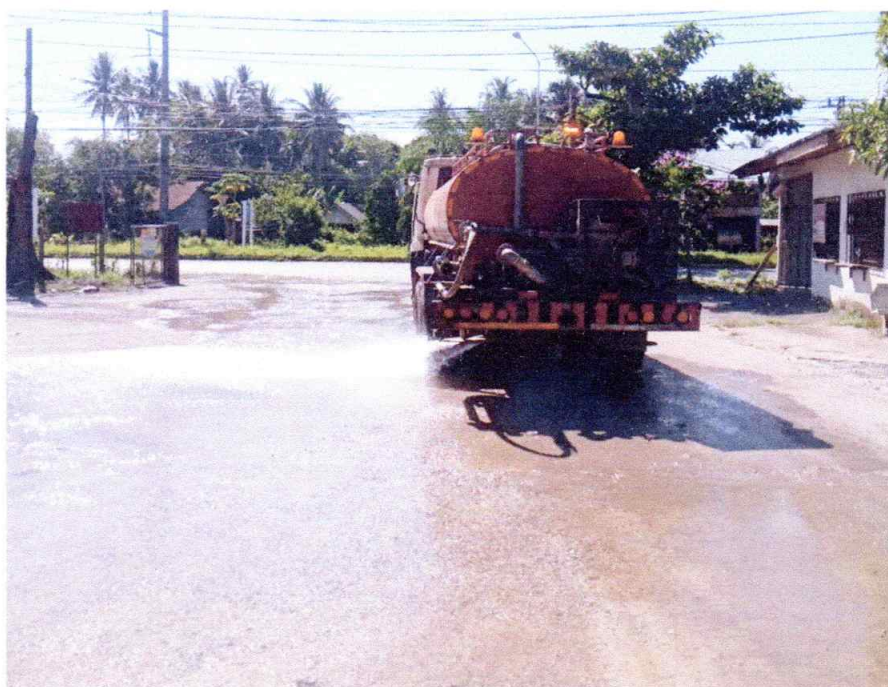
มีรถบรรทุกน้ำและพนักงานฉีดล้างถนนทางหลวงหมายเลข 409 บริเวณหน้าโรงโม่หิน เพื่อทำความสะอาดฝุ่นและดินที่ติดล้อรถถูกค้า จากภายในโรงโม่ออกไปยังถนนหลวงหมายเลข 409
