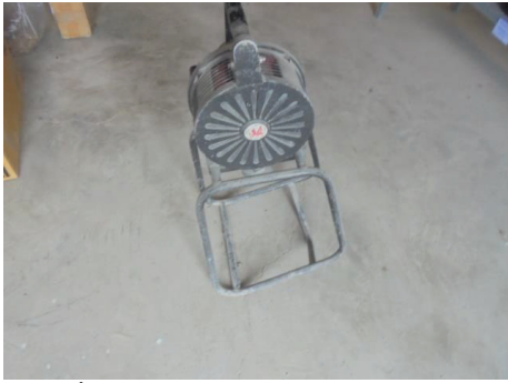
รูปที่ 2-9: หอสัญญาณเตือนการระเบิด
