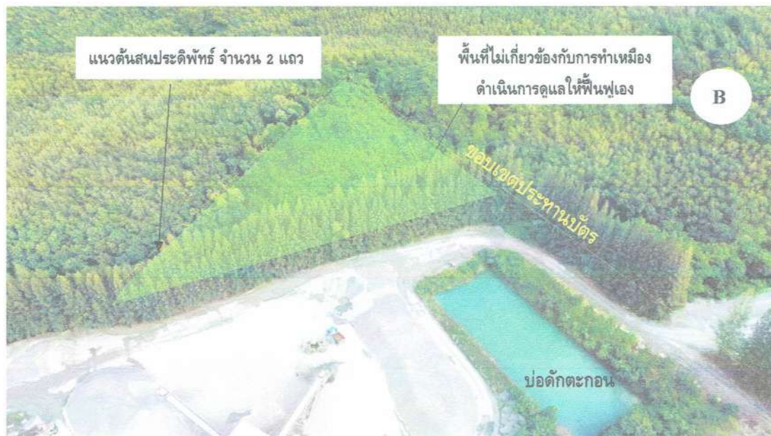
ภาพที่ 2 บ่อดักตะกอนขนาด 40X60X5 เมตร พื้นที่ประทานบัตร 29790/15879
