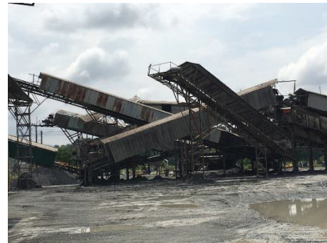
รูปที่ 2-19: การปิดคลุมโรงโม่หิน
