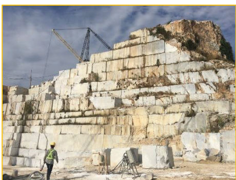
รูปที่ 2-7: หน้าเหมืองแบบขั้นบันได
