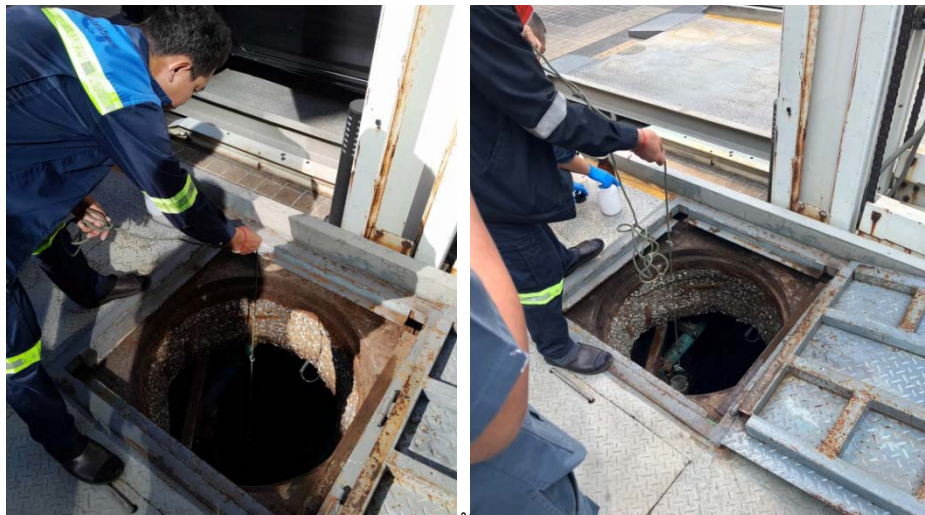
ภาพที่ 5 เก็บตัวอย่างน้ำทิ้งที่บ่อตรวจคุณภาพน้ำทิ้ง
