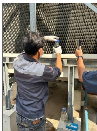
รูปที่ 3.7 การเก็บตัวอย่างเชื้อลีสิจิโอนัลลาจากท่อน้ำทิ้งของระบบปรับอากาศ
