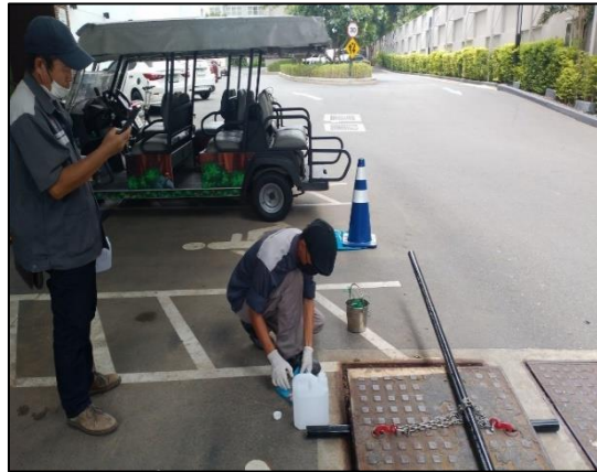
รูปที่ 3.1 การเก็บตัวอย่างคุณภาพน้ำทิ้ง บริเวณจุดปล่อยน้ำเสียก่อนเข้าระบบบำบัดน้ำเสีย
