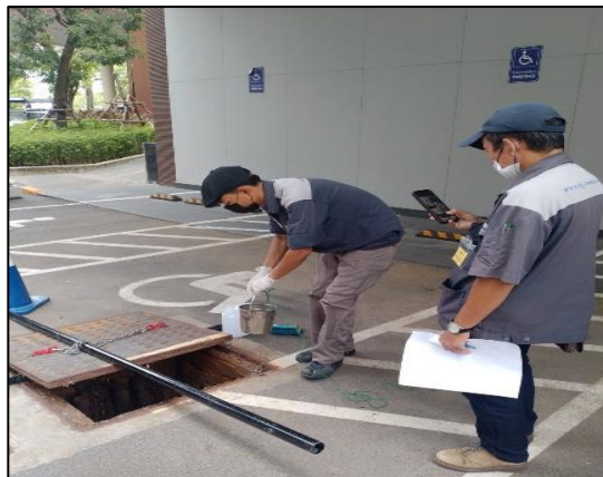
รูปที่ 3.2 การเก็บตัวอย่างคุณภาพน้ำทิ้ง บริเวณจุดปล่อยน้ำทิ้งจากบ่อพักน้ำทิ้ง
