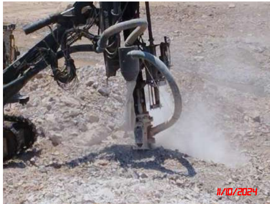
รูปที่ 26 เครื่องเจาะระเบิดที่ติดตั้งอุปกรณ์เก็บฝุ่นไว้บริเวณหัวเจาะ
