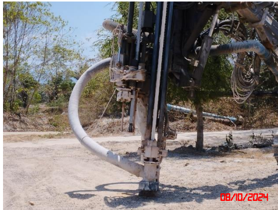
รูปที่ 21 เครื่องเจาะรูระเบิดที่มีอุปกรณ์เก็บฝุ่นติดไว้กับหัวเจาะ
